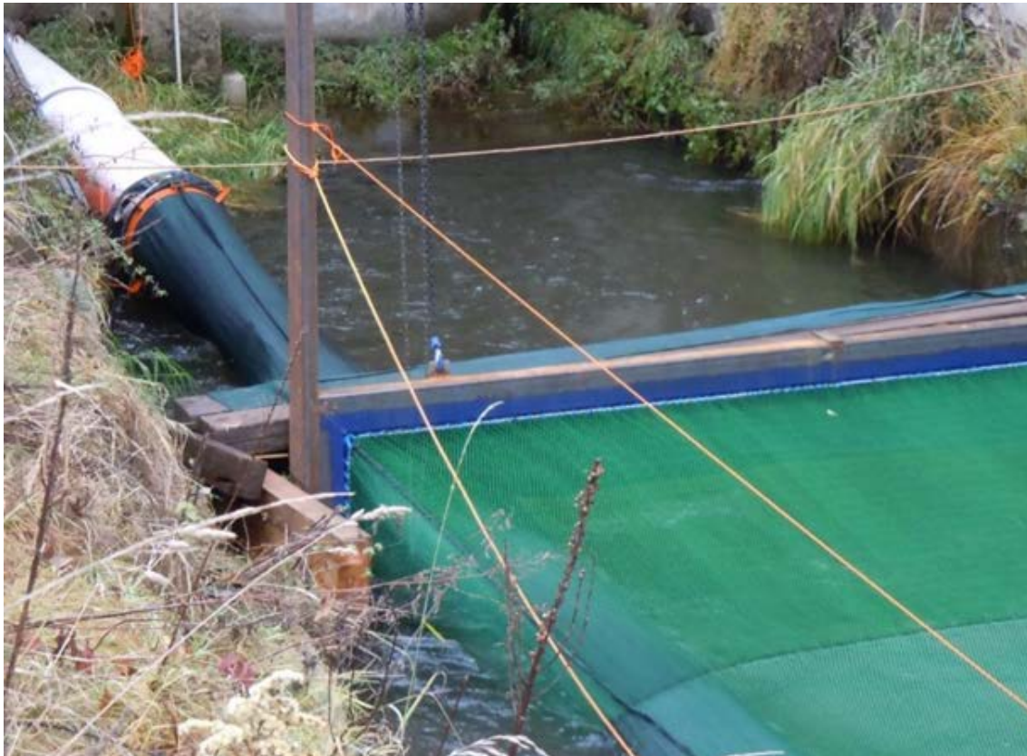
Abbildung 21: Fangsack am Bypassrohr montiert (im Vordergrund: Hamen zur Beprobung der Turbinenpassage).
