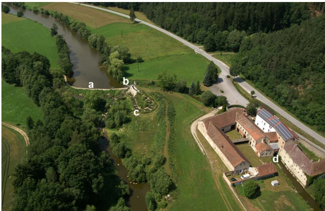
Abbildung 7: Kraftwerksstandort Riedmühle: a) Wehranlage ca 45 m; b) Abzweigung Triebwasserkanal, Tauchwand, Wehrdotations und Fischaufstiegshilfe; c) Fischaufstiegshilfe und Anbindung ins Unterwasser (Restwasserstrecke); d) Krafthaus mit Feinrechen, im OW Tauchwand und Fischabstiegsanlage.
